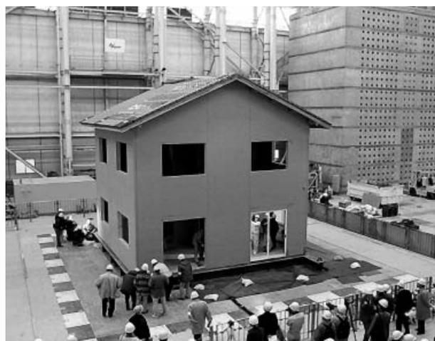
写真1 実大振動台実験
