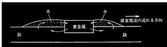
図2 鉄さびの生成機構
