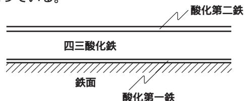
図1 鉄さびの構成
