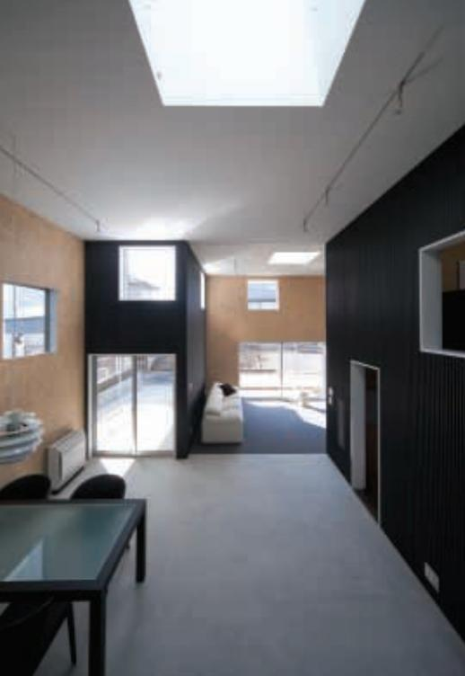
ウム鋼板を使っている。細かい部分を設計する際には、波板の波を合わせ、壁の末端部を少し外に延長させることで、外から内に入り込む構造壁を強調するといった細やかな工夫がなされている。風通しに関しても神経を使い、高低差を利用したわずかな間隙を設け、内部に配置された数々の開口部を通したことで、内部の風環境が悪い空間はなくなったという。
